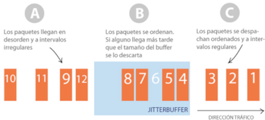
Esquema de funcionamiento de un jitterbuffer
