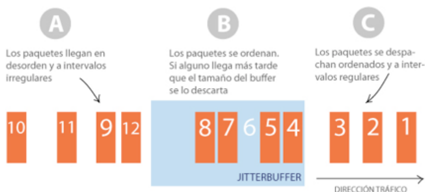
Esquema de funcionamiento de un jitterbuffer
